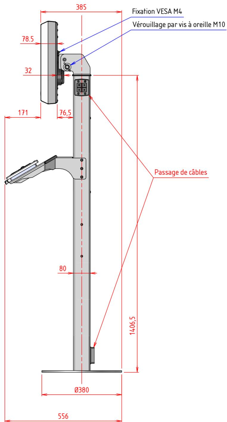
Axe de rotation horizontal :  $-20^\circ / +15^\circ$
